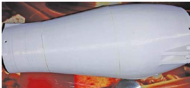
Rysunek 3. Widok zewnętrzny protezy ręki
