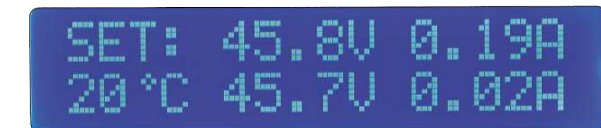
Po skonfigurowaniu jako miernik panelowy wyświetlacz powinien wyglądać tak, jak tutaj, wskazując odczyty napięcia, prądu i temperatury. Jeśli urządzenie jest używane jako wyświetlacz USB, ekran będzie pusty do czasu otrzymania danych z komputera przez port szeregowy USB
