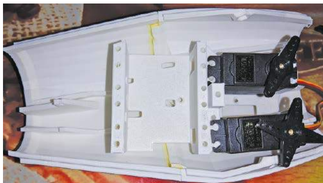
Rysunek 2. Proteza ręki z serwomechanizmem
