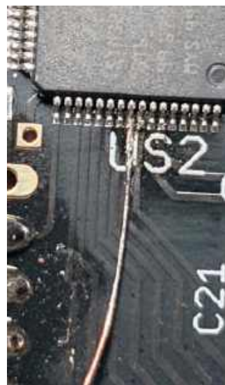
Fotografia 1. Układ w obudowie TQFP64 z dodatkowym doprowadzeniem przylutowanym bezpośrednio do nóżki
