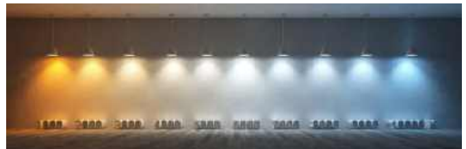
Fotografia 11. Porównanie źródeł światła o temperaturze barwowej od 1000 do 10000 K ( http://t.ly/5cwG7 )
