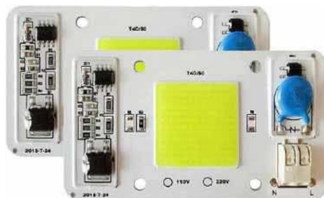
Fotografia 4. Ciekawe moduły COB – oprócz samego emitera na płytce jest też wbudowany zasilacz sieciowy (za: http://t.ly/S0goh )
