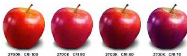
Fotografia 12. Klasyczny przykład obrazujący różnice w percepcji kolorów przy oświetleniu tego samego obiektu za pomocą źródeł o różnych wartościach CRI ( http://t.ly/Fhs74 )
