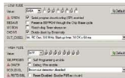
Rysunek 3. Konfiguracja bitów zabezpieczających
