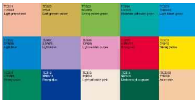
Rysunek 10. Paleta barw testowych stosowana do określenia CRI ( http://t.ly/fWY72 )
