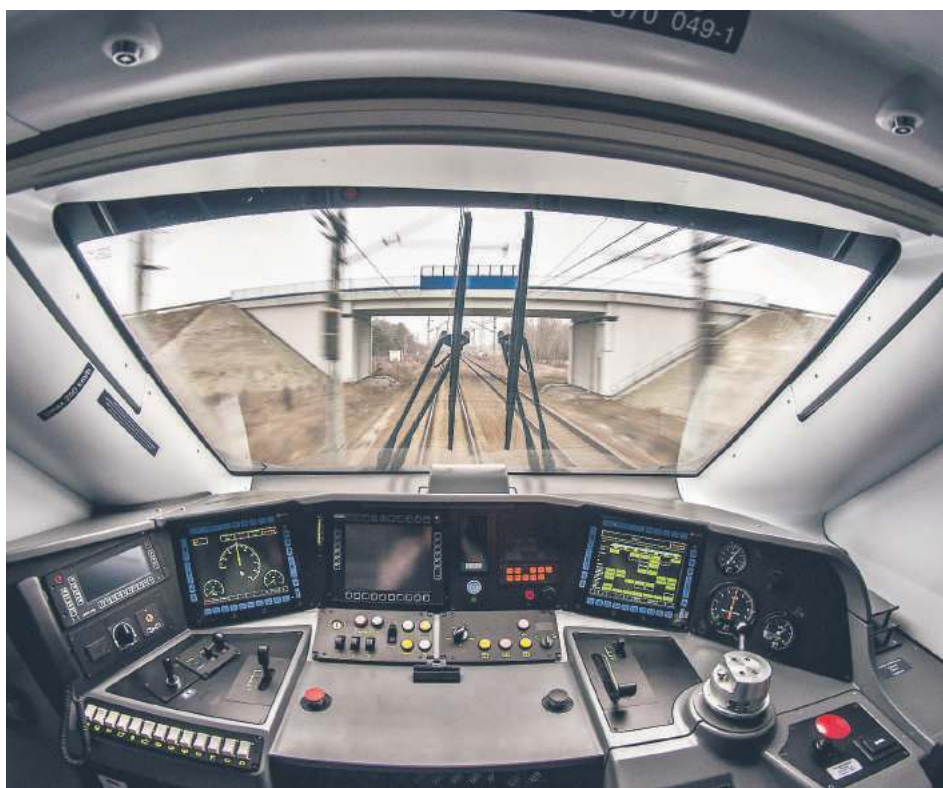
Informacje, wraz z danymi o warunkach przejazdu, dopuszczalnej prędkości i położeniu innych pociągów, trafiają na pulpit maszynisty | fot. mat. pras./d
