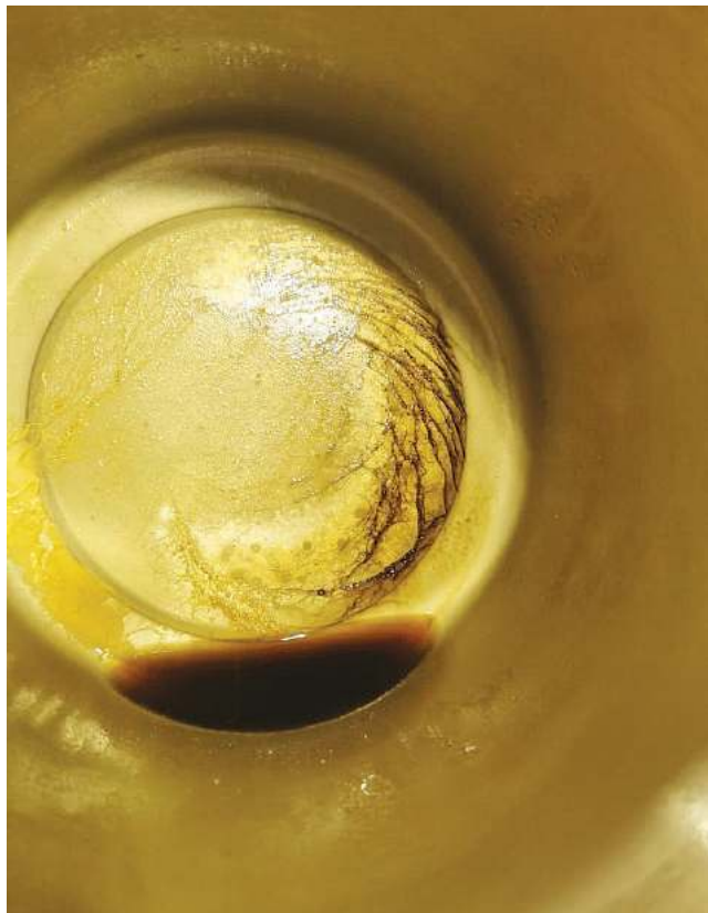
Tak wygląda urządzenie po przedestylowaniu wody z kranu
