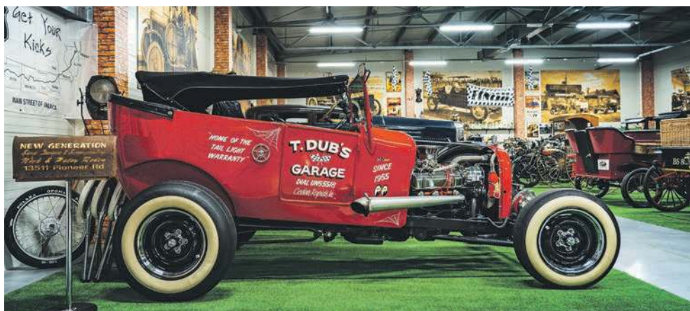
Hot Rod na bazie modelu T z silnikiem V6 Buick-a o pojemności 3,7l i mocy 155 km
