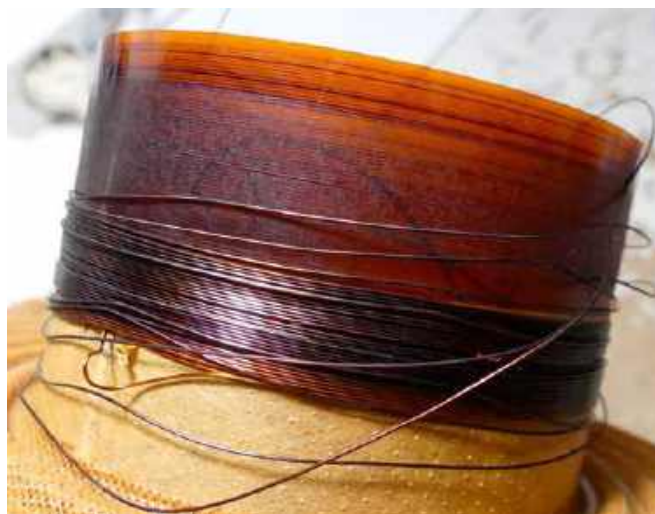
Druga cewka uległa identycznej awarii, spowodowanej wadą technologiczną.
