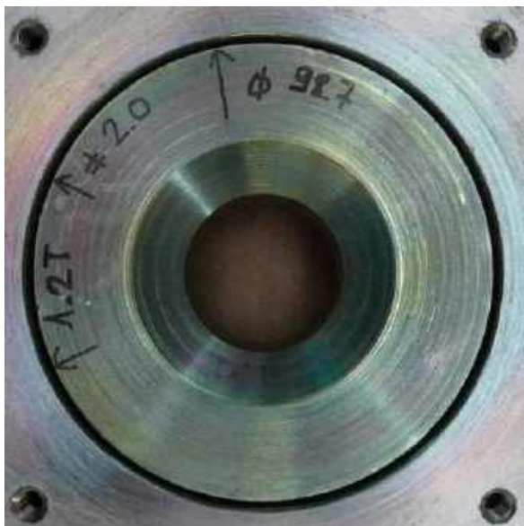
Obwód magnetyczny sklejony przy pomocy precyzyjnego ustalacza.
