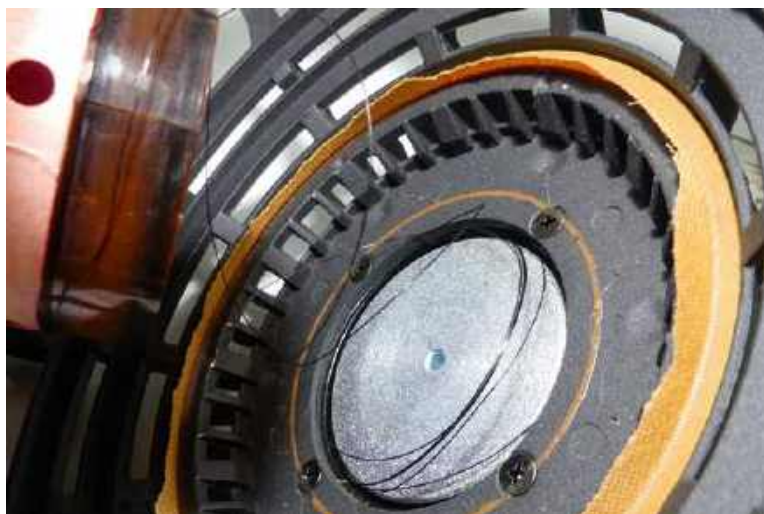
Uzwojenie jednej z cewek w całości znajdowało się w szczelinie obwodu.
