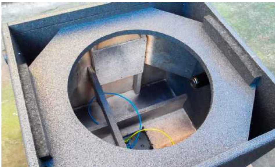
Drewniane kanały bass-reflex dodatkowo usztywniają obudowę.
