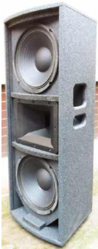
Głośniki 10" w zestawie średnio-wysokotonowym.
