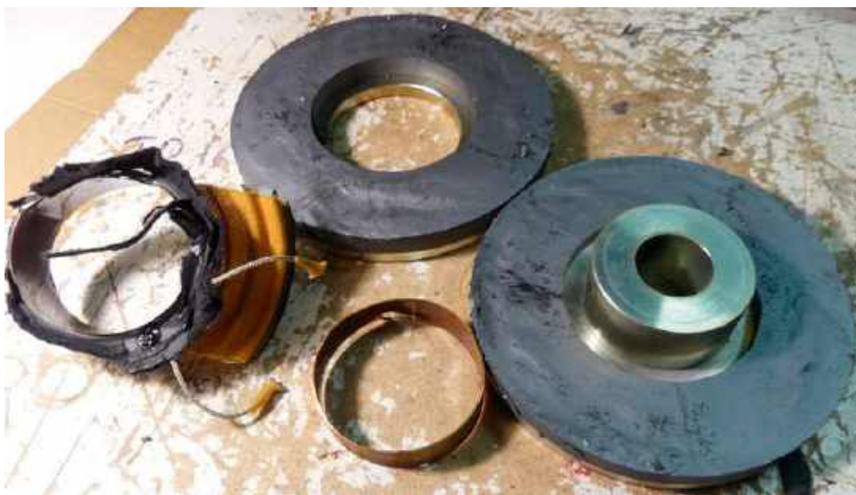
Rozwarstwienie ferrytu doprowadziło do całkowitej destrukcji głośnika.
