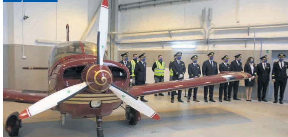
Piper-28 jest amerykańskim samolotem typu „complex”: czteromiejscowym, jednosilnikowym, z chowanym podwoziem i zmiennym skokiem śmigła. Na zdjęciu: uroczyste przekazanie maszyny
