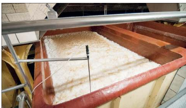
Dział fermentacji. To właśnie tutaj piwo spędza około 7 dni w otwartych kadziach. Po kolorze i konsystencji piany można poznać, czy drożdże wykonały już swoją pracę.
