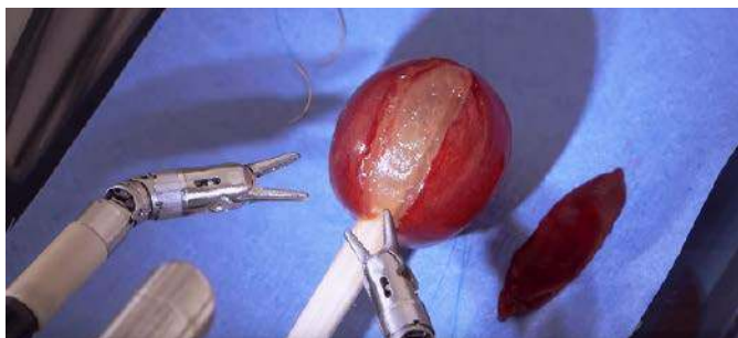
Fotografia 14. Winogrono poddane „operacji” z użyciem robota da Vinci (stan przed zabiegiem) – źródło: t.ly/rvkBG
