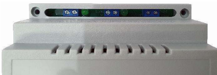
Fotografia 6. Odbiornik zamknięty w dedykowanej obudowie
