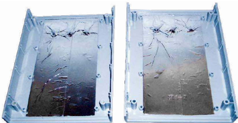
Fotografia 3. Wnętrze obudowy w trakcie ekranowania
