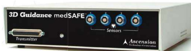
Fotografia 24. Jednostka główna systemu lokalizacji 3D medSAFE marki Ascension (t.ly/YPkwx)
