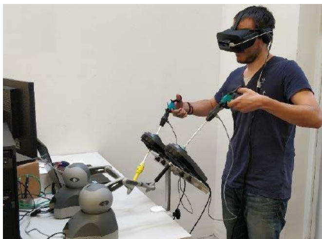
Fotografia 23. Przykład zastosowania okularów VR do obsługi robota chirurgicznego (w tym przypadku sprzęt służy do trenowania modelu AI, mającego wspierać działanie operatora). Źródło: t.ly/iTlhd
