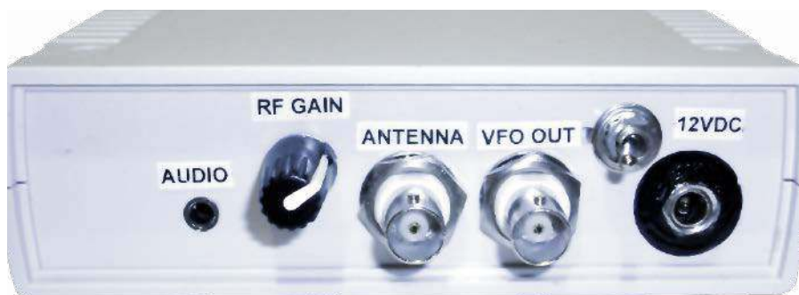
Fotografia 10. Przedni panel odbiornika
