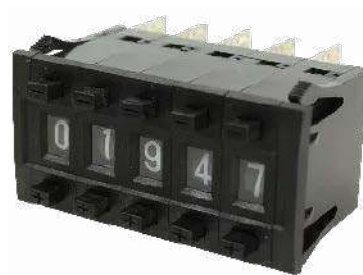
Fotografia 13. Przełącznik kodujący dla liczb do pięciu cyfr (do 99 999) złożony z pięciu modułów
