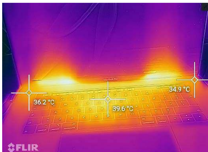
Fotografia 5. Obraz z kamery termowizyjnej, pokazujący rozkład temperatur na powierzchni obudowy i klawiatury laptopa (t.ly/MHiou)
