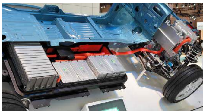
Fotografia 7. Zestaw akumulatorów samochodu elektrycznego Nissan Leaf, widoczny po usunięciu większości elementów podwozia oraz karoserii (t.ly/TQIJT)
