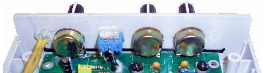
Fotografia 7. Montaż przedniego panelu odbiornika w obudowie
