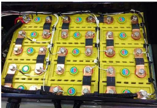
Fotografia 10. Pakiet akumulatorów współpracujący ze scentralizowanym systemem BMS (t.ly/xrWXg)
