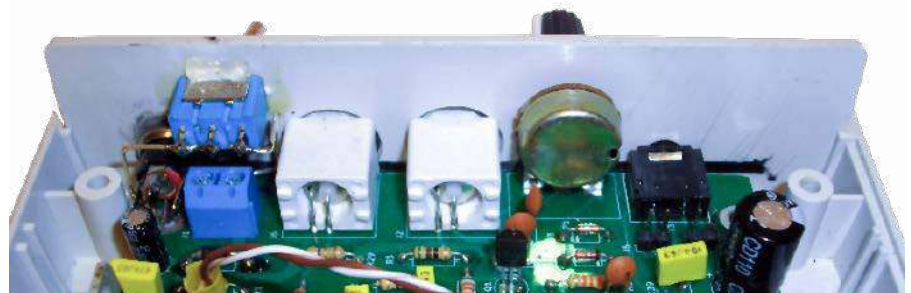
Fotografia 8. Montaż tylnego panelu odbiornika w obudowie
