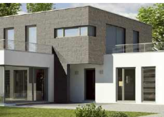
🔗 Betonowych płytek o łupanej powierzchni nie trzeba malować ani przeprowadzać regularnej renowacji. Użycie elementów nadprożowych i bloczków narożnych ułatwia wykończenie załamań i wgłębień. JONIEC
