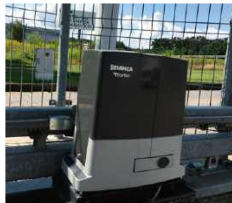
🔗 Bramy przesuwne, zwłaszcza podwieszane, dla wielu osób są synonimem tych automatycznych. Napęd ma postać niewielkiej skrzynki. WIŚNIEWSKI, BENINCA
