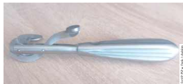
Narzędzie wyglądem przypomina nożyczki i jest wykorzystywane przez strażaków tylko do cięcia biżuterii
