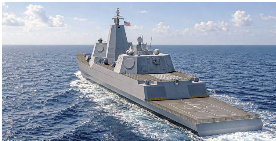
▲ Wczesna wizualizacja typu Defiant od rufy, z pokładem lotniczym dla śmigłowców i bezałogowych statków powietrznych (jednak bez naniesionych zespołów holowanych). Okręt ma pełnić funkcję wielozadaniowej platformy bojowej, zdolnej do działania jako jednostka dowodzenia zespołem okrętów.
