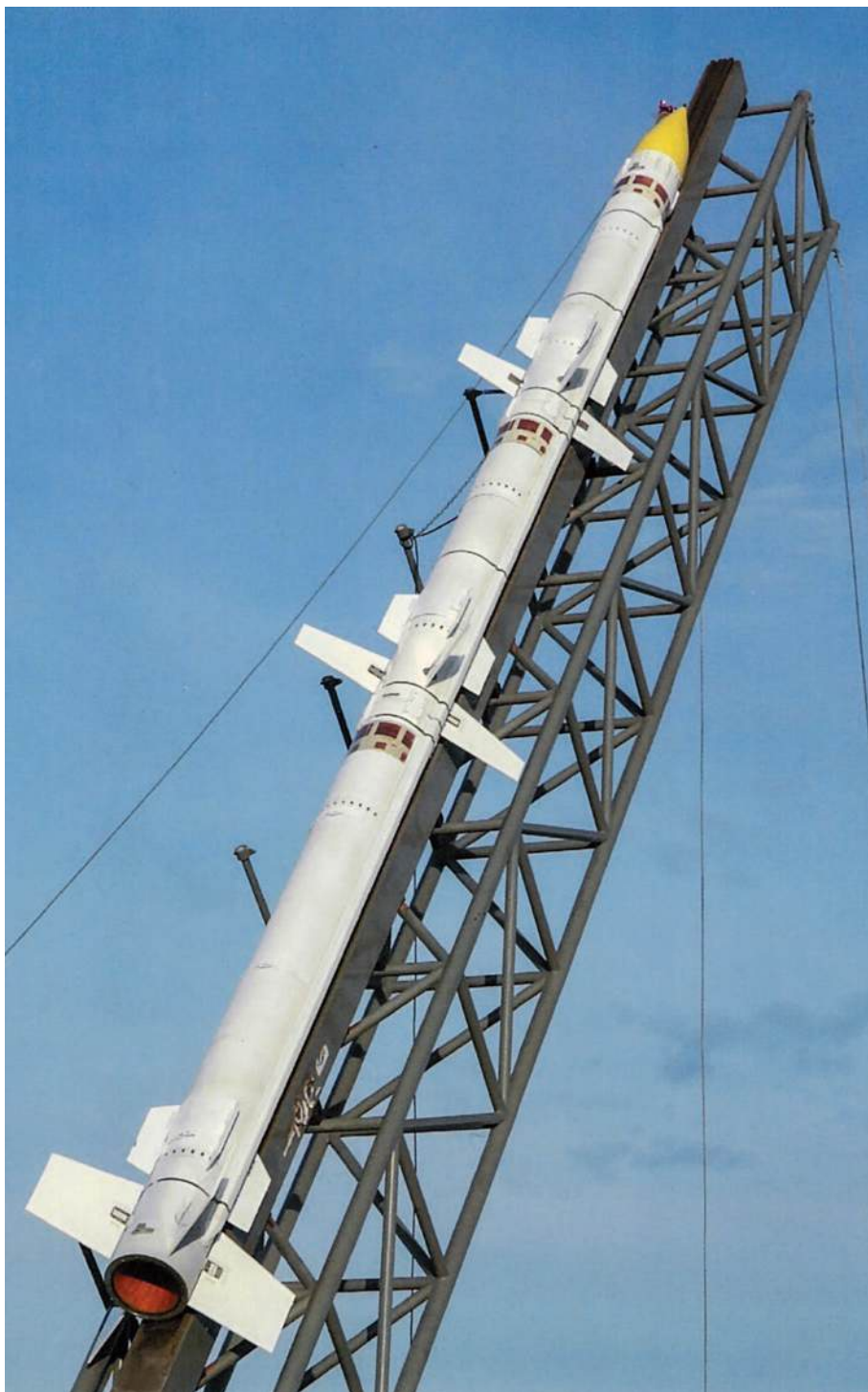
► Trójstopniowa suborbitalna rakiet balistyczna na wyrzutni przed próbnym odpaleniem w listopadzie 2025 r. na poligonie w Wicku Morskim.
