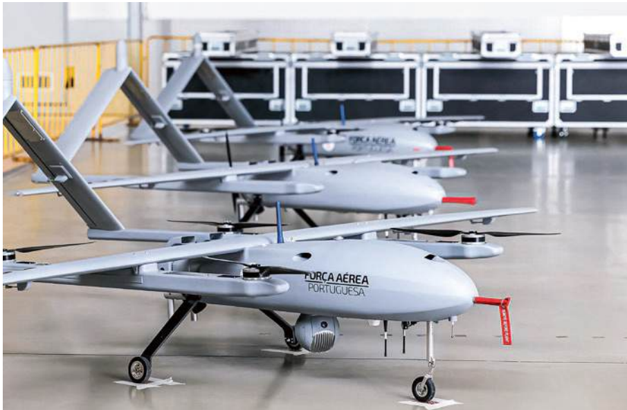
▲ Siły Powietrzne eksploatują od 2020 roku 12 rozpoznawczych bsp rodzimej produkcji UAVision OGASSA OGS 42, w tym osiem w wersji konwencjonalnego startu i lądowania OGS 42N i cztery w wersji pionowego startu i lądowania OGS 42VN.
