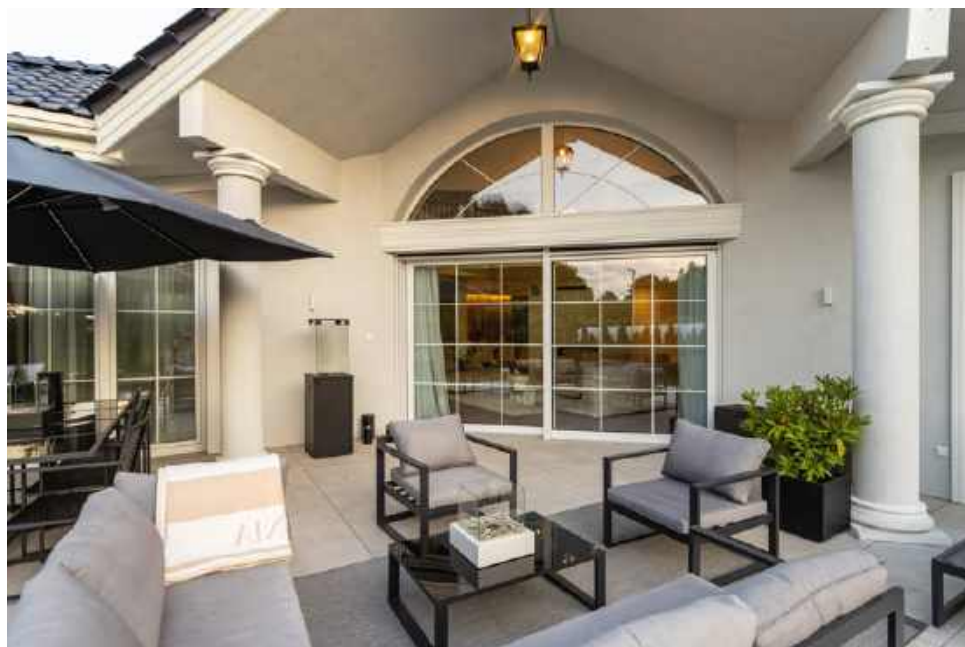
Okna wykonane z wielokomorowych profili PVC są trwałe, odporne na czynniki atmosferyczne, łatwo się je czyści i praktycznie nie wymagają zabiegów konserwacyjnych, z wyjątkiem okresowej regulacji i smarowania okuć. KRISHOME
