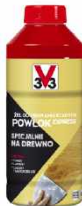
🔧 Środek do usuwania powłok z powierzchni drewnianych. Pędzlem nanosi się warstwę (2–3 mm). Pozostawia na 30 min i usuwa szpachelką lub skrobakiem zgodnie z kierunkiem słojów drewna. Usuwanie warstw w pozycji poziomej ułatwia wnikanie preparatu w głąb usuwanej powłoki. v33
