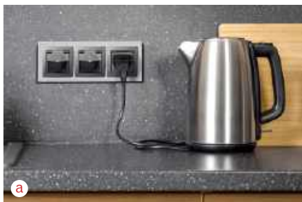
🔌 Gniazda w kuchni, montuje się 20–30 cm nad blatami (a KARLIK), a w łazience na wysokości 110–120 cm od podłogi (b LIVOLO).
