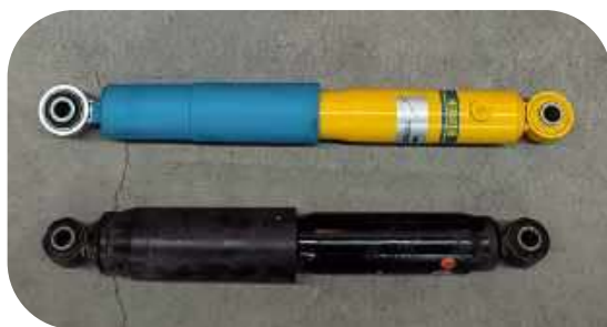
Bilstein B6 Camper (u góry) jest alternatywą dla amortyzatorów seryjnych
