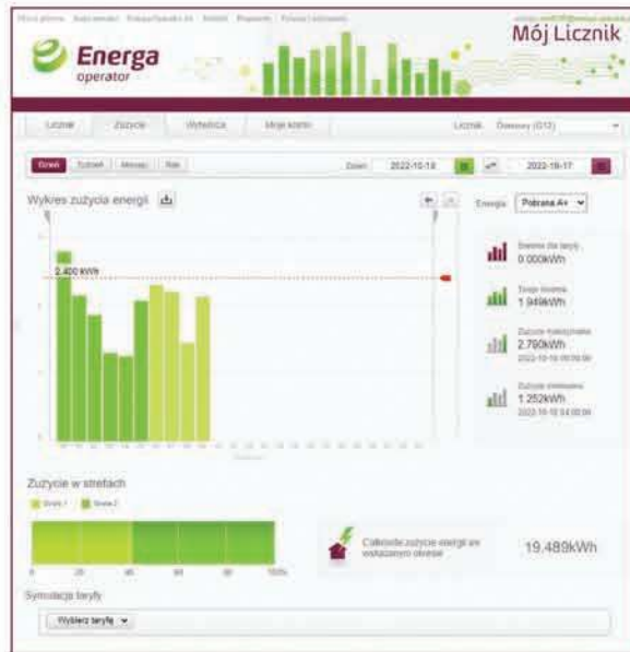
Dzienny wykres zużycia energii elektrycznej z alarmem zużycia ustawionym na 2400 kWh
