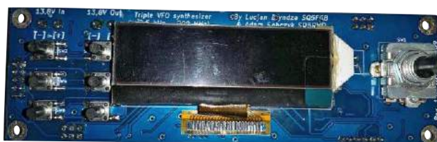
Fotografia 5. System wbudowany z mikrokontrolerem 32-bitowym
