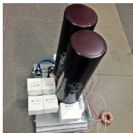
Fotografia 13. Wygląd zmontowanego falownika
