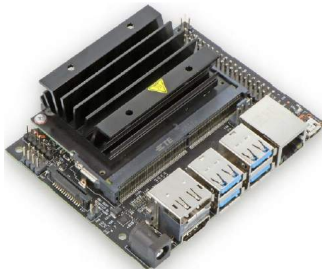
Fotografia 17. Komputer SBC Nvidia Jetson Nano
