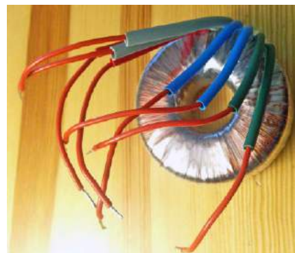
Fotografia 3. Transformator zasilający układy sterujące
