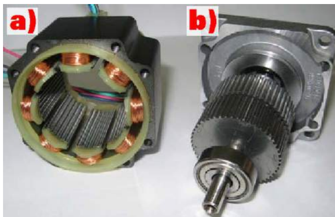
Fotografia 6. Silnik hybrydowy: a) stator, b) rotor
