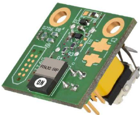
Fotografia 1. Moduł IoT z funkcją energy harvesting
