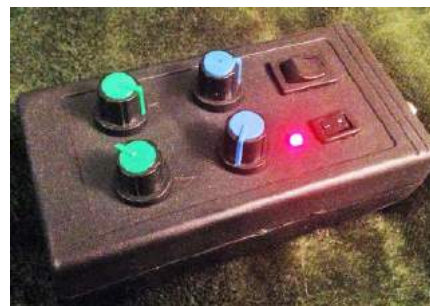
Fotografia 4. Interrupter – moduł kontrolujący parametry pracy cewki
