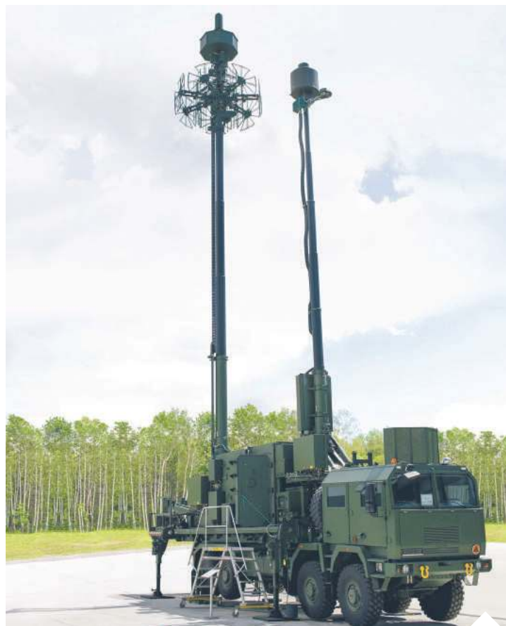
Stacja radiolokacyjna dalekiego zasięgu P-18PL. PCL/PET, znany także jako System Pasywnej Lokacji (SPL) | fot. PGZ
