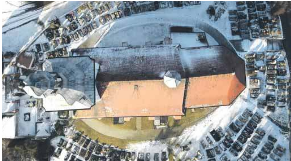
Kościół jest z cegły, otynkowany, wzniesiony na planie prostokąta, z trójbocznie zamkniętym prezbiterium. Od strony frontowej znajduje się czworoboczna wieża zwieńczona barokowym hełmem
