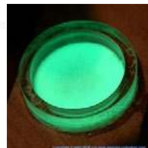
Świecąca mieszanina chlorku prometu(III) i siarczku cynku ( https://en.wikipedia.org/wiki/Promethium(III)-chloride )
