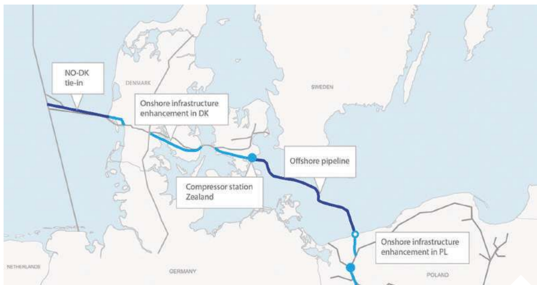
Dzięki Baltic Pipe z Norwegii do Polski będzie można sprowadzić rocznie 10 mld m sześć. gazu ziemnego | fot. mat. pras/d
