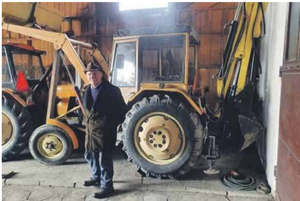
Jeden z siedmiu traktorów skonstruowanych przez Józefa Pajerskiego, nazywany przez wnuka „Małym Ostrówkiem”. Z przodu ma urządzenie służące do ładowania drewna. Z tyłu - wielofunkcyjny ładowacz, który można wykorzystywać m. in. jako minikoparkę do robót ziemnych.
