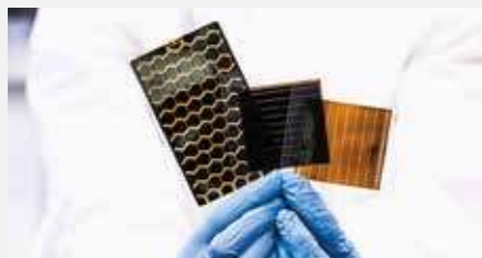
Polska fizyk Olga Malinkiewicz opracowała technologię wytwarzania elastycznych ogniw fotowoltaicznych FOT. SAULE TECHNOLOGIES
